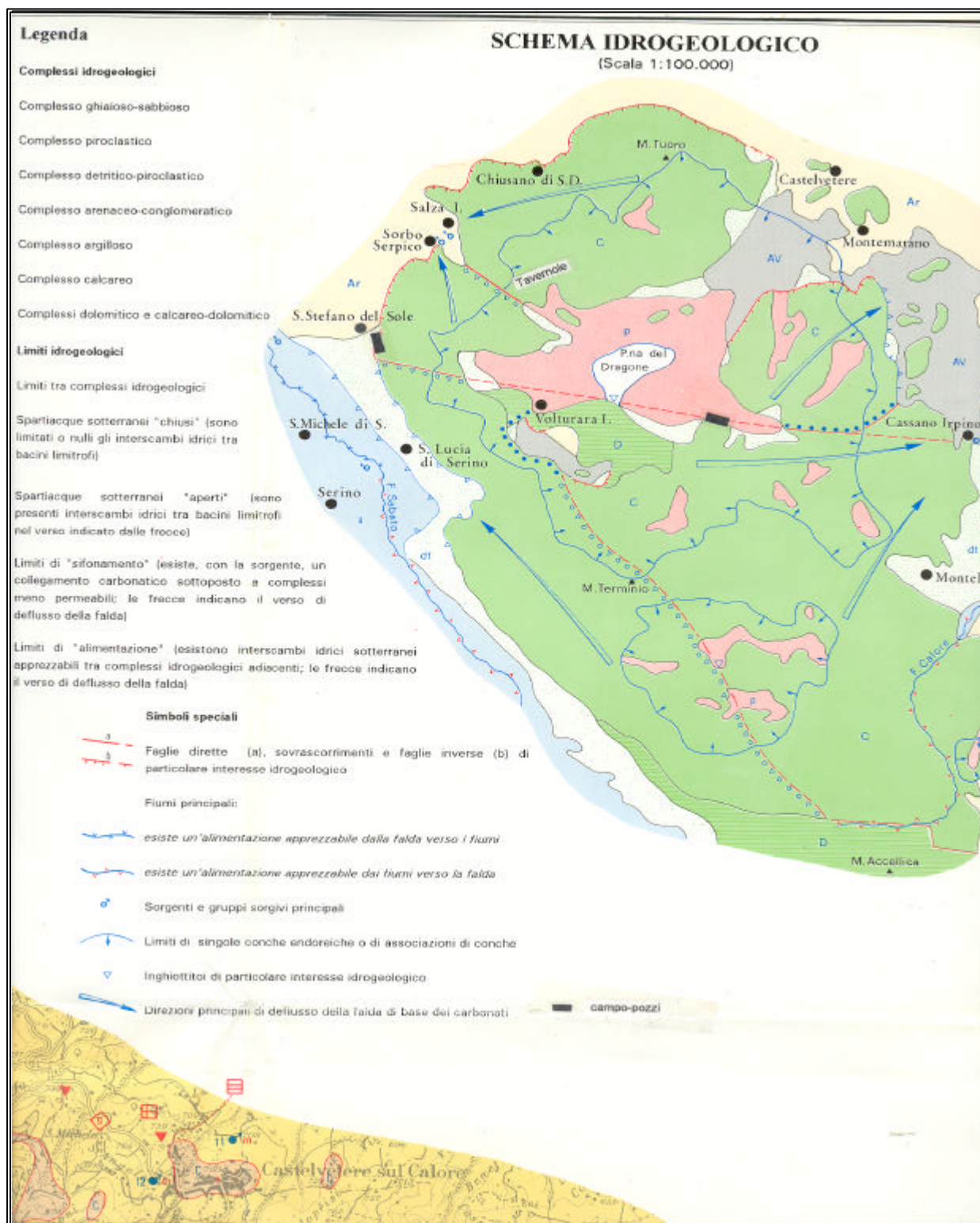
Fig. 9 - Schema di circolazione idrica sotterranea dell'idrostruttura carbonatica di Monte Terminio - Tuoro.
